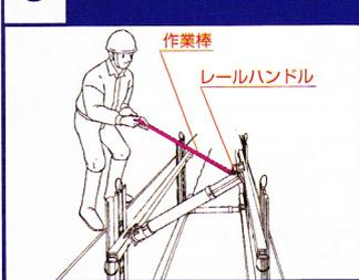
4 作業棒の先端のソケットをジャッキのスバナロに差し込み、ラチェットレンチをセットし、仮締めする。
